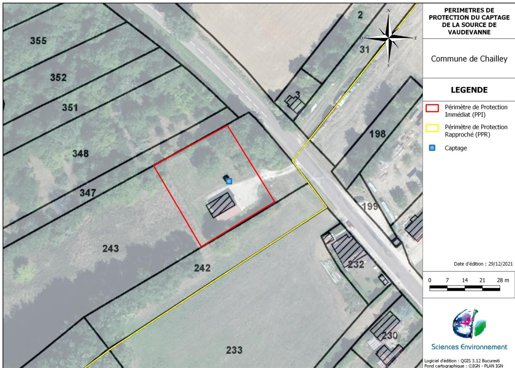
Figure 1 : délimitation du PPI (Périètre de Protection Immédiate) du captage de la source de Vaudevanne
